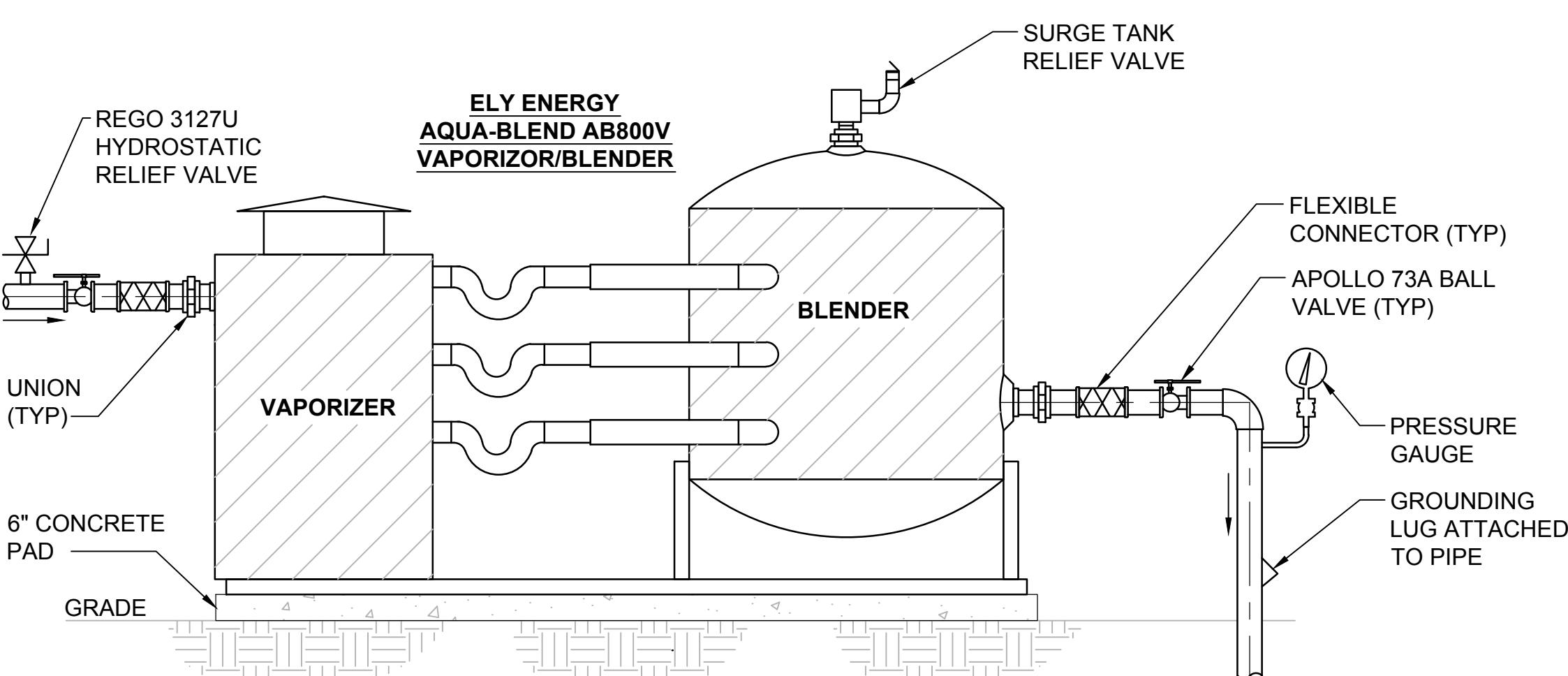
**VAPORIZER PIPING DETAIL**
